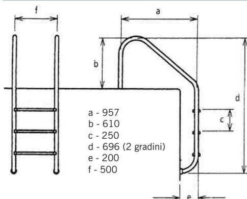
In acciaio inox Aisi 304, completa di ancoraggio, copriflangia inox, tappi in gomma, gradino in acciaio inox antiscivolo.
