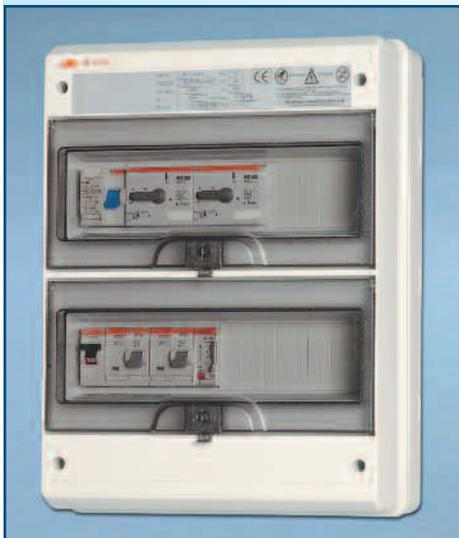
Con differenziale per piscina a skimmer composto da: contenitore stagno IP 65 a 36 moduli con porta trasparente, 2 salvamotori regolabili per pompa. 2 teleruttori per pompa. 2 Selettori M o A, comando pompa. Timer giornaliero con riserva di carica. Interruttore automatico 16 A per fari (Massimo 6). Differenziale puro 2 poli 30 mA.
