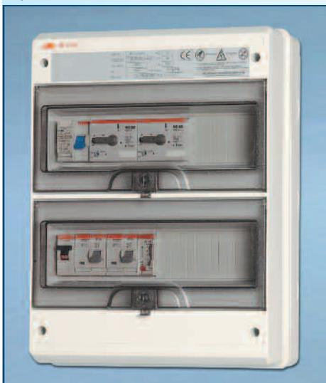
Con differenziale per piscina a skimmer composto da: contenitore stagno IP 65 a 36 moduli con porta trasparente, 2 salvamotori regolabili per pompa. 2 Teleruttori per pompa. 2 Selettori M o , comando pompa. Timer giornaliero con riserva di carica. Interruttore automatico 16 A per fari (Massimo 6). Differenziale puro 4 poli 30 mA.
