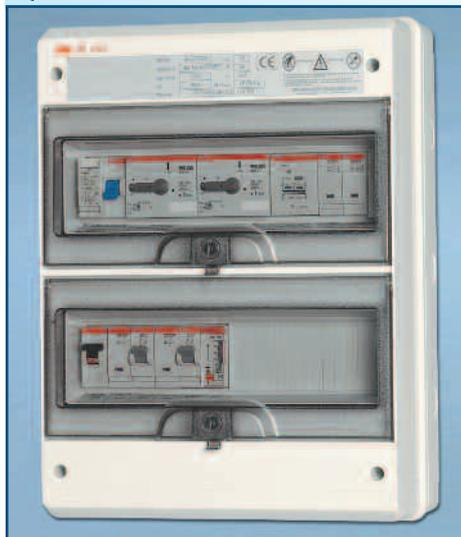
Quadro per piscine con bordo sfioratore, con trasformatore per livelli e differenziale, composto da: Contenitore stagno IP 65 a 36 moduli con porta trasparente. 2 Salvamotori regolabili per pompe. 2 Teleruttori per pompe. 2 Selettori M o A comando pompa. Interruttore automatico per fari massimo 6. Trasformatore 30 VA, 220/24V. Relè per massimo livello. Differenziale puro 4 poli 30 mA.
