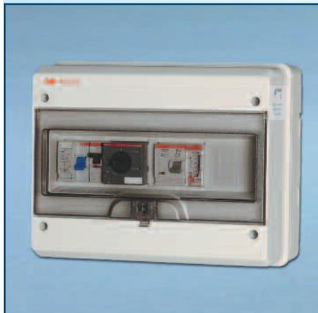
Con differenziale per piscina a skimmer composto da: contenitore stagno IP 65 a 12 moduli con porta trasparente, salvamotore regolabile per pompa. Teleruttore per pompa. Timer giornaliero a cavalieri con riserva di carica. Selettore M o A, comando pompa. Interruttore automatico 16 A per fari (Massimo 6). Differenziale puro 4 poli 30 mA.
