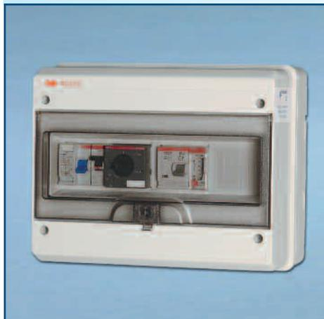
Con differenziale per piscina a skimmer composto da: contenitore stagno IP 65 a 12 moduli con porta trasparente, salvamotore regolabile per pompa. Teleruttore per pompa. Timer giornaliero a cavalieri con riserva di carica. Selettore M o A, comando pompa. Interruttore automatico 16 A per fari (Massimo 6). Differenziale puro 2 poli 30 mA.
