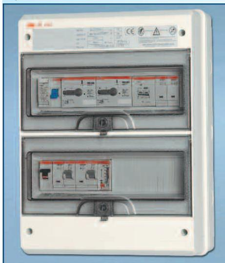
Quadro per piscine con bordo sfioratore, con trasformatore per livelli e differenziale, composto da: Contenitore stagno IP 65 a 24 moduli con porta trasparente. Salvamotore regolabile per pompa. Teleruttore per pompa. Timer giornaliero a cavalieri con riserva di carica. Selettore M o A comando pompa. Interruttore automatico per fari massimo 6. Trasformatore 30 VA, 220/24V. Relè per minimo livello. Differenziale puro 4 poli 30 mA.
