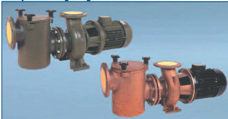
Pompa centrifuga di grande portata. Corpo pompa, supporto, prefiltro, giunzione e girante costruita in ghisa. Albero e cestello prefiltro in acciaio inox AISI 316. Grado di protezione IP 54. 2850 RPM.
