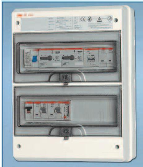
Quadro per piscine con bordo sfioratore, con trasformatore per livelli e differenziale, composto da: contenitore stagno IP 65 a 24 moduli con porta trasparente. Salvamotore regolabile per pompa. Teleruttore per pompa. Timer giornaliero a cavalieri con riserva di carica. Selettore M o A comando pompa. Interruttore automatico per fari massimo 6. Trasformatore 30 VA, 220/24V. Relè per minimo livello. Differenziale puro 2 poli 30 mA.
