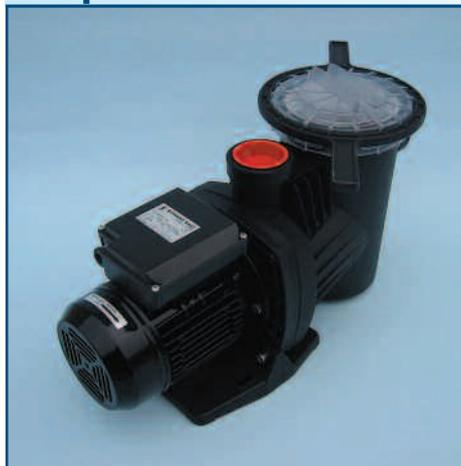
Pompa autoadescante con prefiltro incorporato di grandi dimensioni. Coperchio trasparente in policarbonato, la base e il diffusore sono costruiti in polipropilene rinforzato con fibra di vetro resistente ai prodotti chimici. Giranti in Noryl. Tenuta meccanica in carbone/ceramica. Viti Inox.
