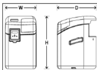
IL COPERCHIO DEL CABINATO, STAMPATO AD INIEZIONE, E' COSTRUITO IN DUE PEZZI: UNO A COPERTURA E PROTEZIONE DELLA VALVOLA ED UNO PER IL CONTROLLO DEL LIVELLO SALE E PER IL CARICO DELLO STESSO
